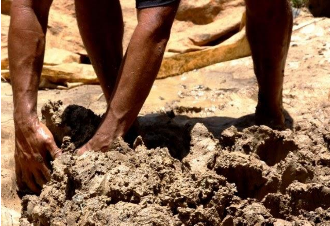
Fig. 7 - A argila é retirada diretamente no mangue próximo, área protegida por estar em situação de risco ambiental. É trabalhada em condição de alta umidade para ser modelada em técnica de rolete. O serviço de coleta de barro e preparação na primeira amassadura e retirada de raízes hoje é feito por homens, pois é considerado "trabalho hoje duro demais". Fonte: Arquivos da pesquisa (2009). Fotografia de Marcela Antunes.
